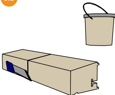
Application de résine organique de finitions fournis sur le contour des jonctions. Effectuer cette enduction en deux passes, une première afin de «bourrer» la jonction jusqu'au mastic préalablement appliqué. Après séchage de cette première passe, poncer la résine et appliquer une seconde passe dite de lissage afin d'assurer une finition parfaite de la jonction.
