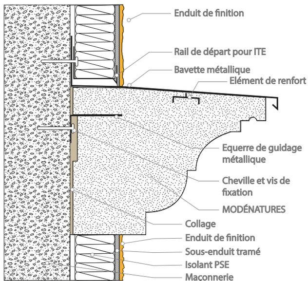
Pose sur support béton
