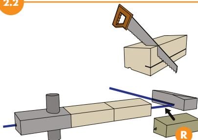
L'élément de réglage (R) viendra s'insérer entre le dernier élément standard et le premier élément de l'angle. L'élément de réglage est à découper le cas échéant pour être ajusté à l'espace. Tenir compte des largeurs du joint.
