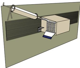
Appliquer un double encollage en plein sur la totalité des surfaces des joues de chaque élément avec la colle MSP fournis pour assurer la solidarisation des éléments entre eux (Assurer la bonne application sur 100% des deux tympans entre profilés afin de permettre une jonction de 2 à 3mm d'épaisseur maximum. Après la prise de la colle MSP, enlever le surplus à l'aide d'un cutter pour fermer un joint creux permettant l'enduit de finitions.
