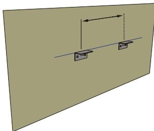
Traçage au bleu sur le support en vue du positionnement des équerres d'alignements à raison de deux équerres par élément de 1,5m (prévoir une équerre centrale complémentaire pour les éléments >1,5m). Attention : le bon positionnement des équerres induit l'alignement des profils. Fixation des équerres à adapter au support. Se référer à notre avis technique.
