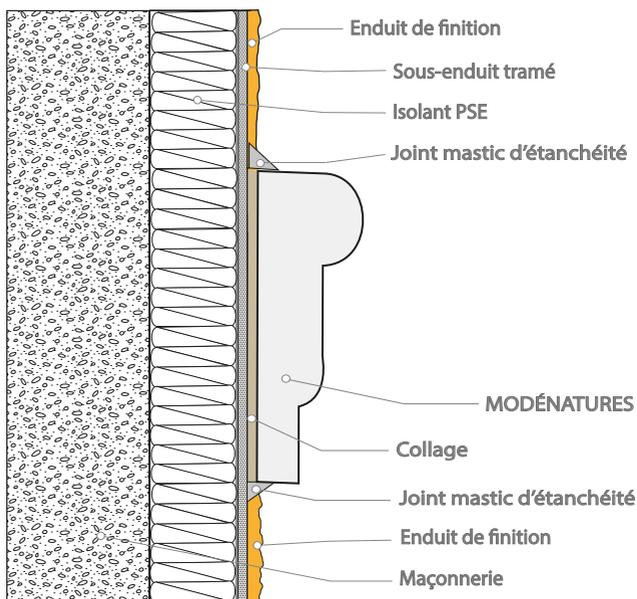
Pose sur supports béton
