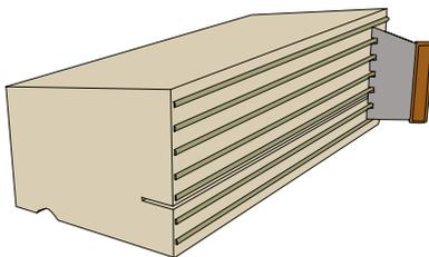
Préparation du mortier colle suivant les préconisations de dosage du fournisseur et mise en œuvre des modénatures par double encollage (100% de la surface arrière de la modénature et du support - «plots de colles» interdit).
