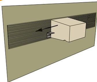
Positionner immédiatement l'élément sur le support et le maroufler par un va-et-vient afin d'obtenir le tack optimum entre les différentes parties.
